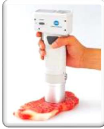
Resim 1.5: Kırmızı ette cihazla renk ölçümü
